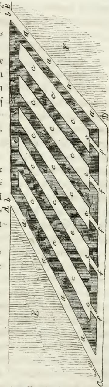
aus den Kanälen c, c, c, zusammenrutschen. Hier befindet sich das Schlußwerk, durch welches ihr Hinausfallen aus den Shoots regulirt wird.
